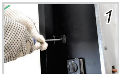
Com uma chave philips, retire os parafusos de ambos os lados do equipamento que prendem a moldura.
