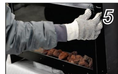
Remonte o equipamento utilizando os parafusos que foram retirados para colocação das pedras.
